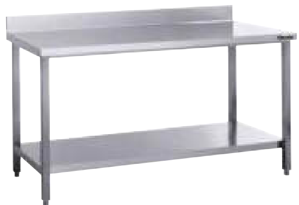
Arbeits Tisch (Anlieferung als Bausatz) Aufkantung hinten: 100mm, Untergestell: Vierkantrohr mit Zwischenboden, Material: Edelstahl 18/10, BxTxH: 1000 x 700 x 850mm höhenverstellbar bis 900mm
