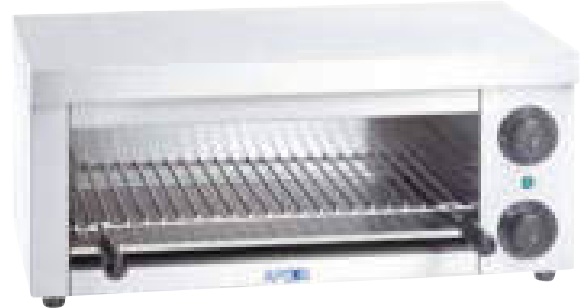
Salamander 500-1Z Gehäuse aus Chromnickelstahl, Zeitschaltuhr inkl. 1 Rost, Anschlußwert 230 Volt, 2 kW BxTxH 630 x 320 x 290 mm 269,00 Euro
